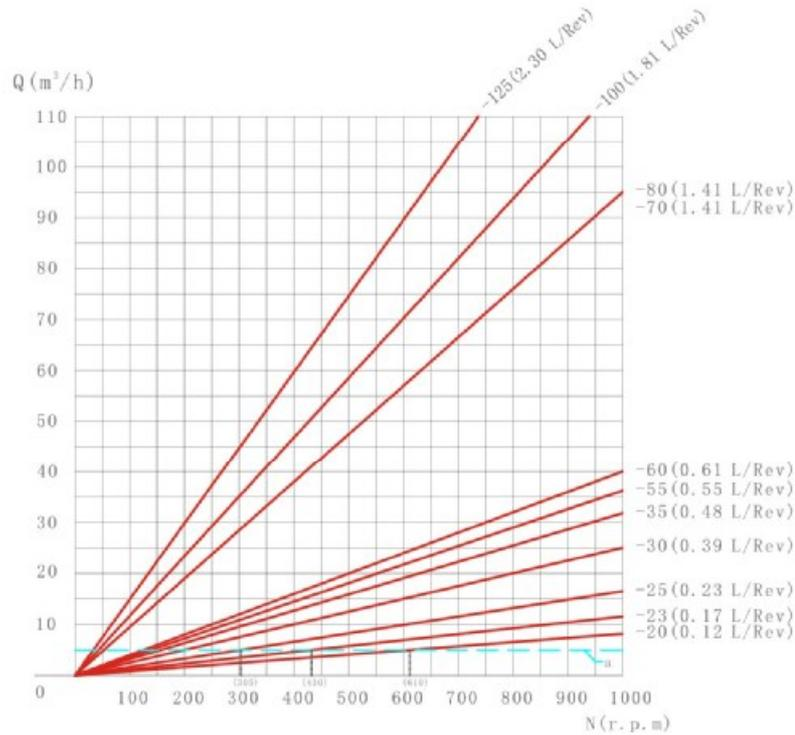
说明：流量计算公式 $Q=0.06K \cdot N$ ，其中Q：流量(T/h)，K：排量系数(L/转)，N：转速--200-1000 (r.p.m)
